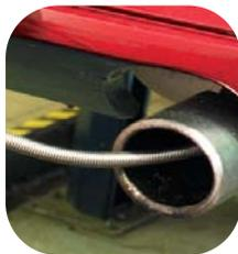
**1** Tan sólo inserte la sonda en el tubo de escape y tome una muestra de las lecturas de gases con el analizador KANE.
